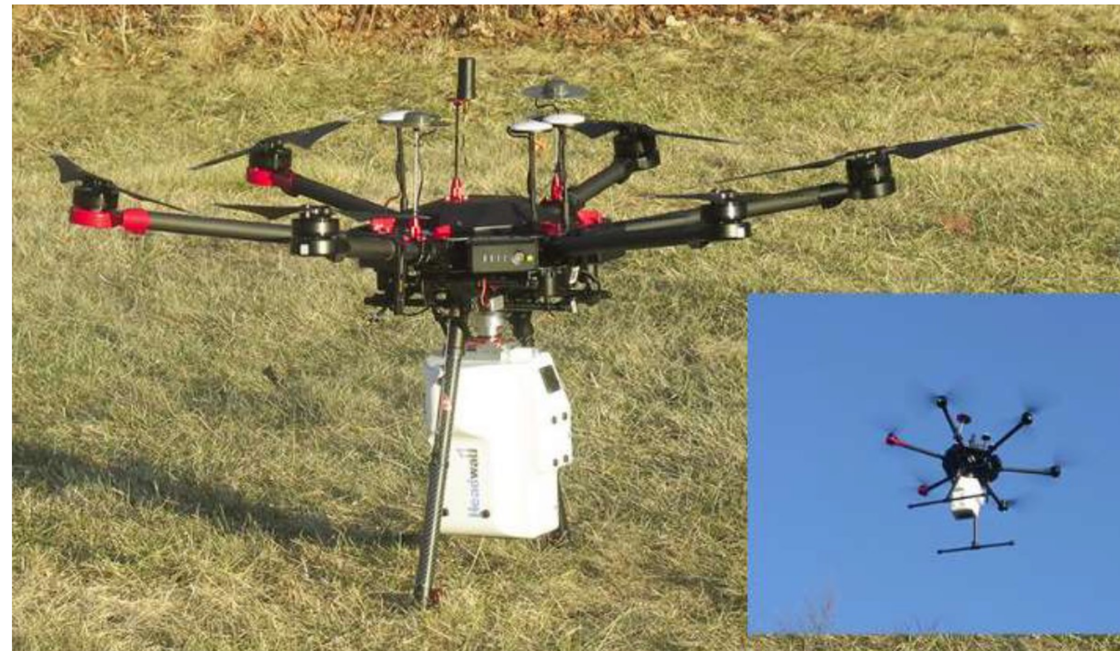
Système co-aligné VNIR-SWIR sur DJI M600P
